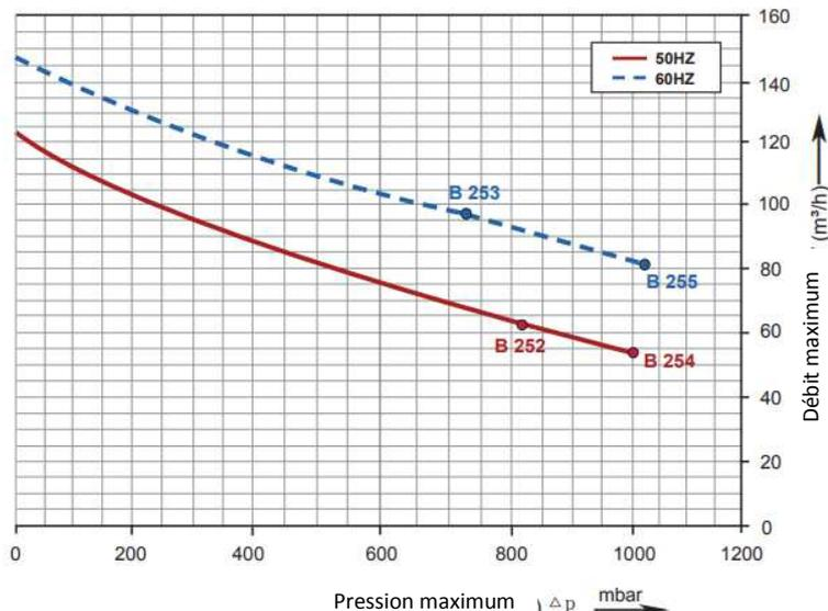
Les courbes de performances sont réalisées avec un air à 15°C et une pression atmosphérique de 1013Mbar. La tolérance est de +/- 10%.
