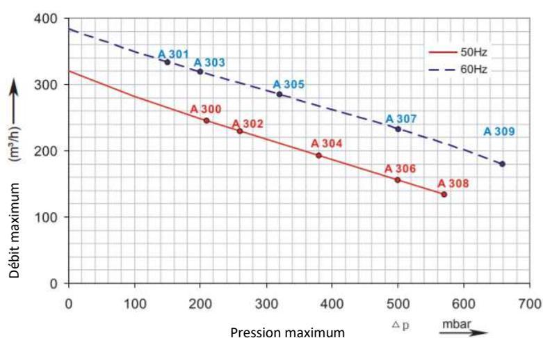
Les courbes de performances sont réalisées avec un air à 15°C et une pression atmosphérique de 1013Mbar. La tolérance est de +/- 10%.
