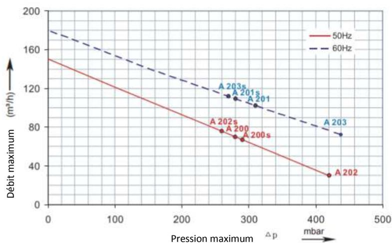
Les courbes de performances sont réalisées avec un air à 15°C et une pression atmosphérique de 1013Mbar. La tolérance est de +/- 10%.
