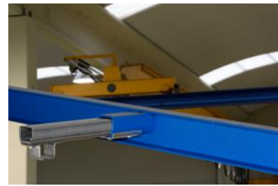
BRAS SOUDES A LA POUTRE
