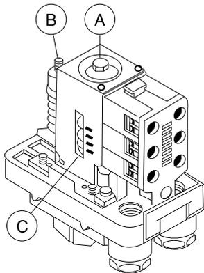
Le réglage s'effectue en agissant sur l'écrou A pour obtenir le point haut (pression de déclenchement) et sur l'écrou B pour régler le point bas (pression d'enclenchement).
